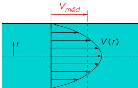
Devido à condição de não-escorregamento (aderência) a velocidade do fluido em contato com as paredes do duto é zero. Na linha de centro é máxima. Em escoamentos internos é conveniente utilizar o conceito de **velocidade média**,  $V_{med}$  ou  $\bar{V}$ , para utilizar, o conceito de escoamento uniforme numa seção.
