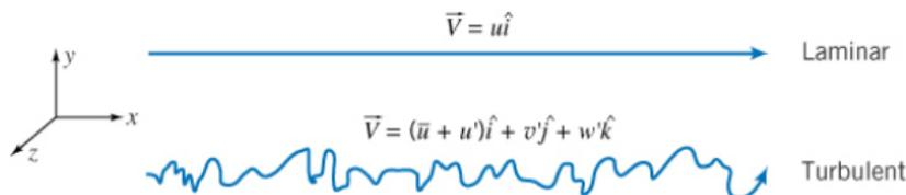
Um escoamento laminar é aquele onde as partículas movem-se em camadas lisas, ou lâminas. Quando o fluido é translúcido tem aparência "vitrificada".
