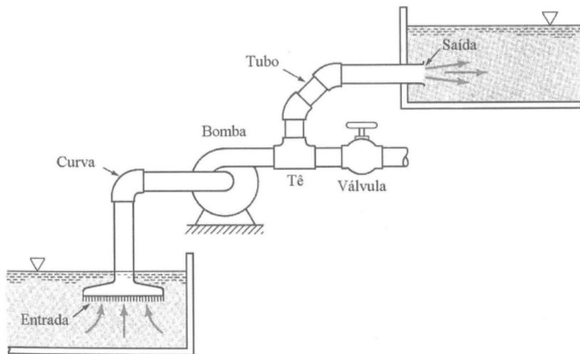
Muitos são os componentes que, juntos, compõem os sistemas de tubulações. Os principais são: trechos retos de tubos e/ou dutos; e conexões. As conexões são de grande variedade: válvulas; cotovelos (ou joelhos) e curvas (raios mais longos); tês; filtros, etc. Além desses componentes as bombas e ventiladores são partes essenciais desses circuitos, uma vez que são eles que promovem o escoamento.
