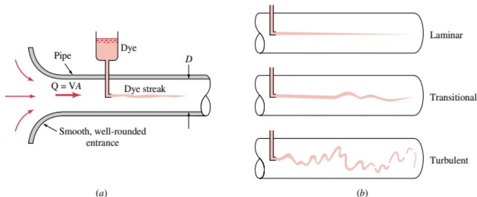
Há mais de um século Osborne Reynolds (1842 - 1912) idealizou o seguinte experimento: injetar um filete de tinta num escoamento através de um tubo transparente. Na figura ao lado, o resultado esquemático obtido.
