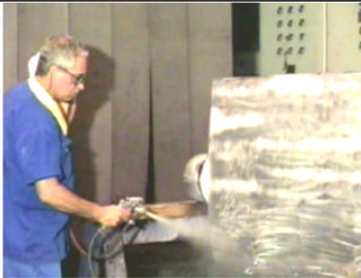
Aplicação do revelador por pulverização com pistola de pintura
