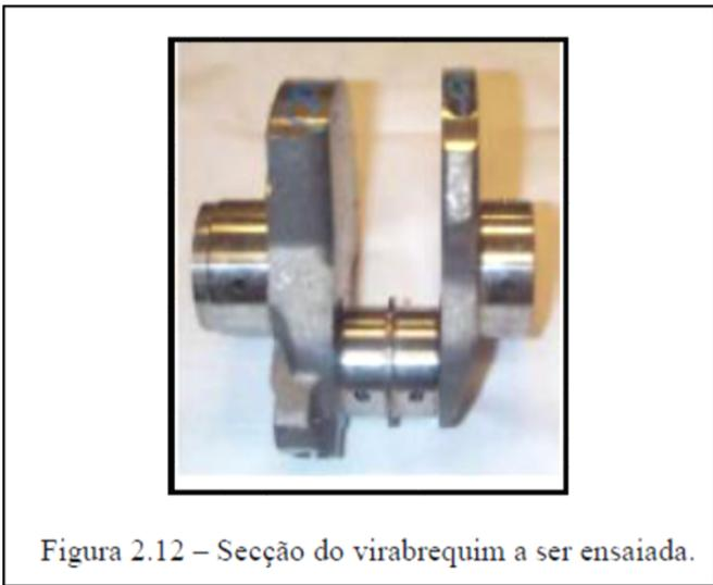
Figura 2.12 – Secção do virabrequim a ser ensaiada.
