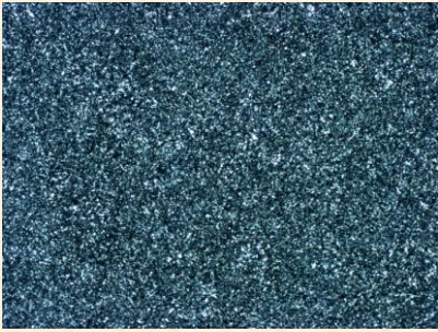
Cristalização rápida de gordura de palmiste a 10°C
