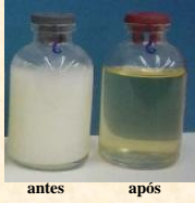
Amostras a 20°C da mistura binária de estearina de frango e TCM antes e após a interesterificação
