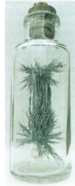
FIG. 28-4 (a) Linhas de campo magnético nas proximidades de um ímã em forma de barra. (b) Um “ímã de vaca”, ímã em forma de barra introduzido no rúmen das vacas para evitar que pedaços de ferro ingeridos acidentalmente cheguem ao intestino do animal. A limalha de ferro revela as linhas de campo magnético. (Cortesia do Dr. Richard Cannon, Southeast Missouri State University, Cape Girardeau)
