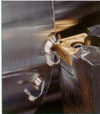
Vista aproximada de uma operação de torneamento com ferramenta de carbeto cementada (*detalhe a direita*) com múltiplas coberturas (*detalhe à esquerda*). *Abaixo*, diagrama esquemático do modelo bidimensional de corte e a seção transversal da cobertura
