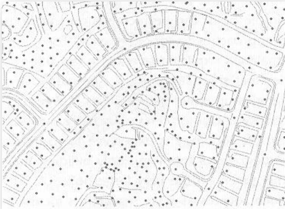
Conjunto de pontos de uma amostra e *break-lines*.
