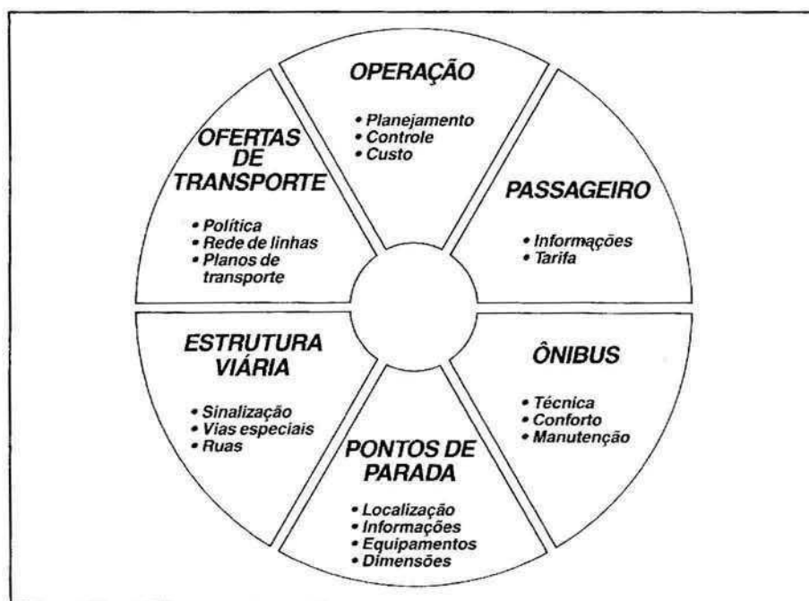
Figura 14 - Componentes do sistema de transporte coletivo urbano por ônibus.
