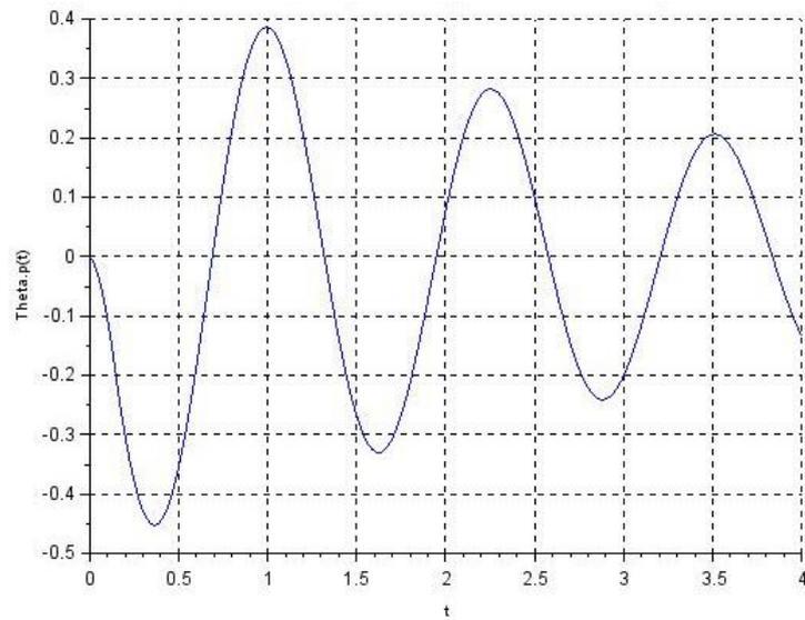
Figura 3: Velocidade Angular ( $\omega$ ) para entrada degrau.
