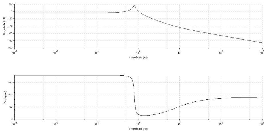
Figura 9: Diagrama de bode considerando entrada e saída em suspensões distintas.
