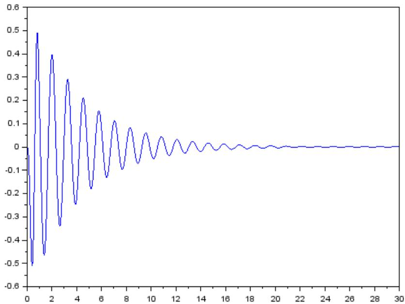
Figura 5: Velocidade Angular ( $\omega$ ) para entrada seno em fase.
