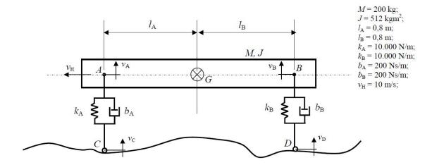
Simule o sistema de suspensão para entrada do tipo degrau. Considere condições iniciais nulas e tempo de simulação de 4 segundos.
