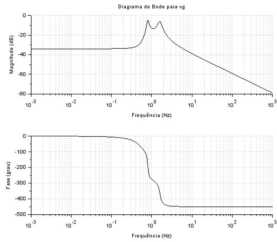
Figura 6: Diagrama de Bode para  $v_G$
