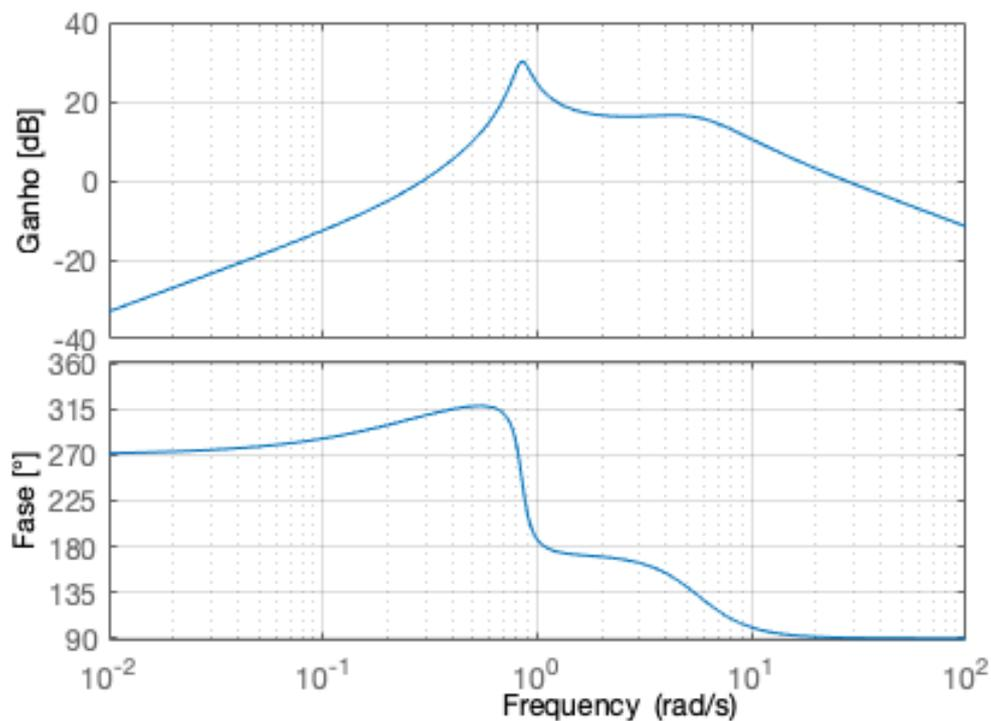
Figura 7.2: Diagrama de Bode na variável  $q$
