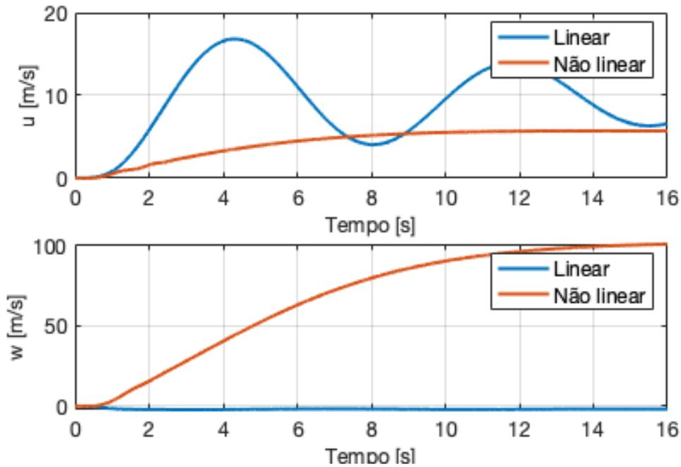
Figura 7.7: Comparação entre o modelo linear e não linear para perturbação rampa
