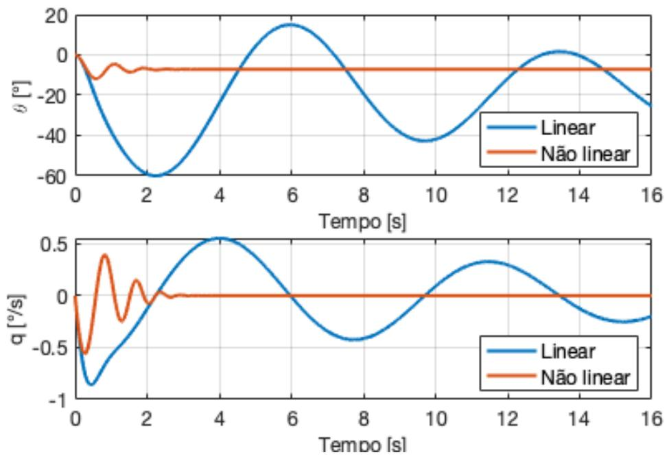
Figura 7.5: Comparação entre o modelo linear e não linear para uma perturbação degrau
