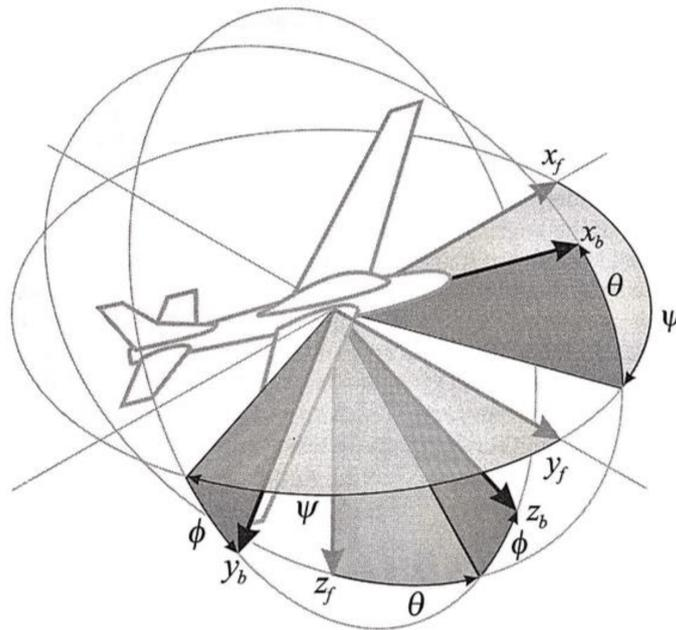
Figura 6.1: Sistemas de eixos adotado
