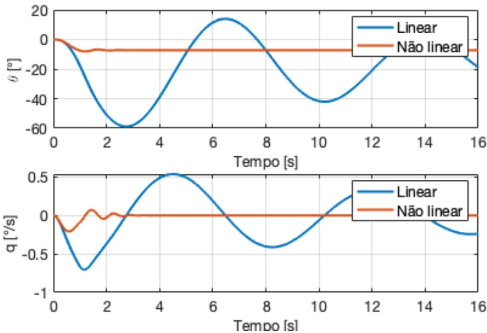
Figura 7.8: Comparação entre o modelo linear e não linear para uma perturbação rampa
