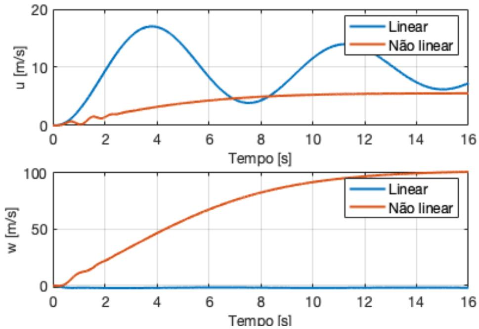
Figura 7.4: Comparação entre o modelo linear e não linear para uma perturbação degrau
