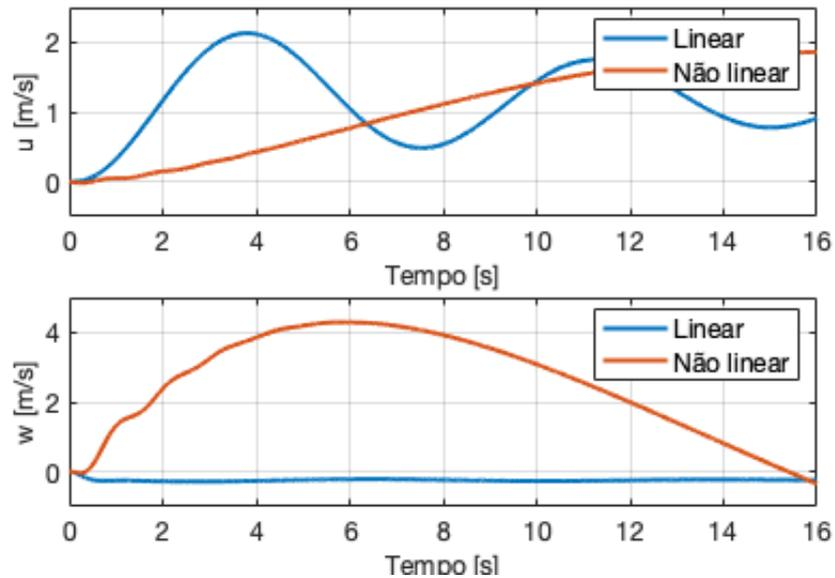
Figura 7.9: Comparação entre o modelo linear e não linear para uma perturbação impulso
