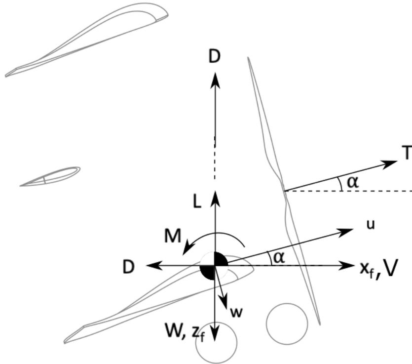
Figura 6.4: Diagrama de corpo livre da aeronave
