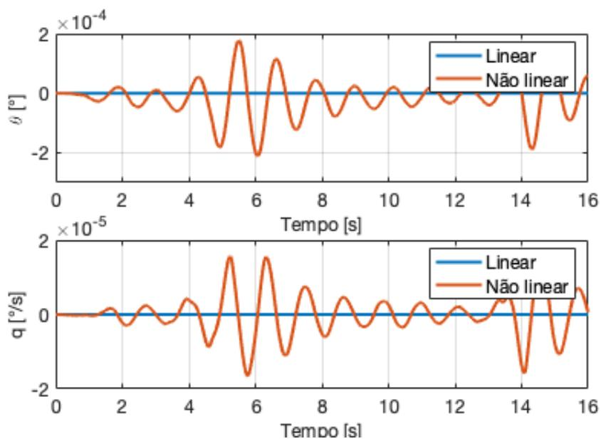
Figura 7.10: Comparação entre o modelo linear e não linear para uma perturbação impulso
