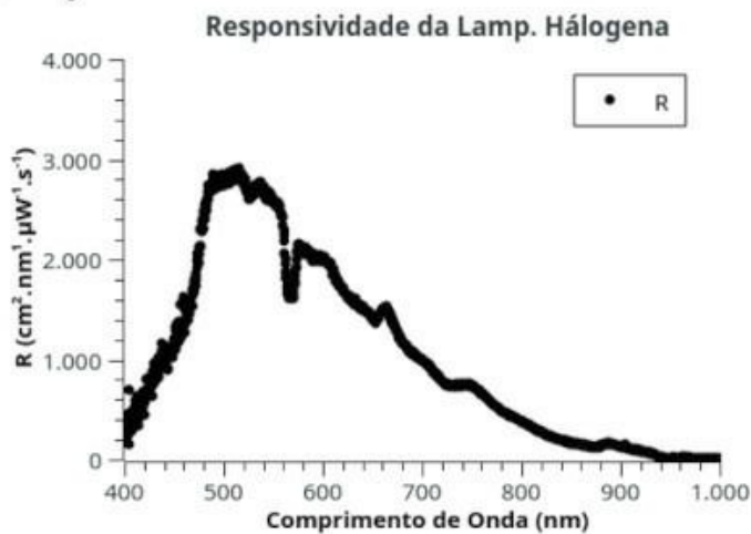
Figura 5: Responsividade do espectrômetro.
