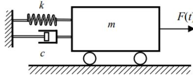
Simule o sistema para diferentes valores de  $m$ ,  $c$  e  $k$ , de tal forma que se tenha uma simulação para cada um dos três casos a seguir:  $\zeta = \frac{b}{2\sqrt{km}} < 1$ ,  $\zeta = \frac{b}{2\sqrt{km}} = 1$ ,  $\zeta = \frac{b}{2\sqrt{km}} > 1$
