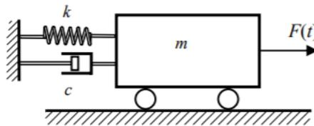
Figure 1 Sistema mecânico
