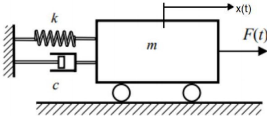
Figura 1: Sistema massa, mola e amortecedor
