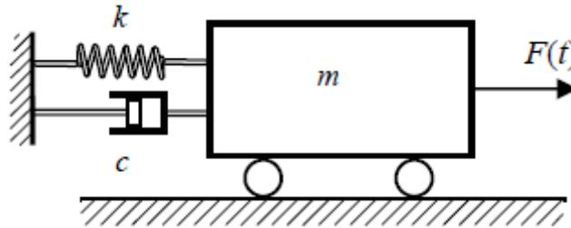
Simule o sistema para diferentes valores de  $m$ ,  $c$  e  $k$ , de tal forma que se tenha uma simulação para cada um dos três casos a seguir:
