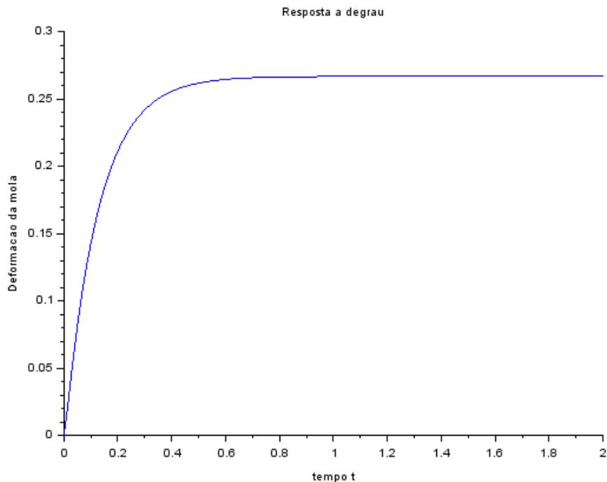
Observa-se um sistema supercrítico.
