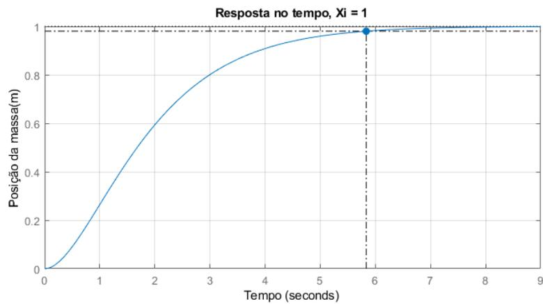
Figura 4: Sistema massa-mola-amortecedor, terceira simulação
