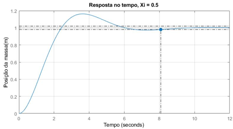
Figura 3: Sistema massa-mola-amortecedor, segunda simulação
