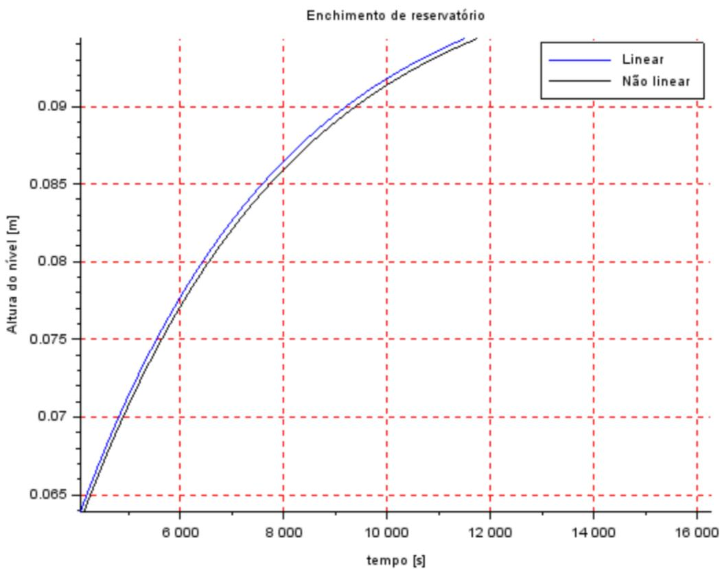
Os dois gráficos demonstram a mesma situação. O primeiro demonstra o comportamento do sistema até a condição final e, para o segundo, foi utilizado um intervalo de tempo de 4000s a 10000s para demonstrar a diferença de comportamento entre linear e não linear.
