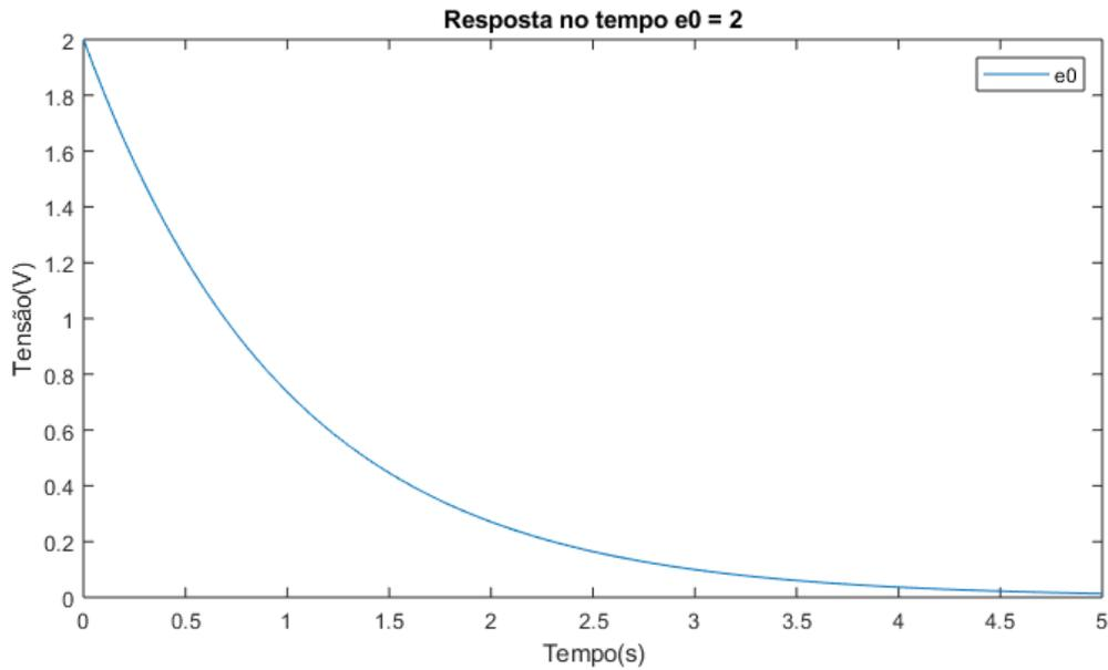
A resposta do sistema elétrico, qualitativamente, se comporta identicamente à aproximação linear do sistema com um reservatório. Tal resultado é esperado, tendo em vista que o tanque se comporta como uma capacitância fluídica, e a válvula/restrição, como uma resistência fluídica. Desse modo, o circuito elétrico apresentado é análogo ao circuito fluídico estudado.
