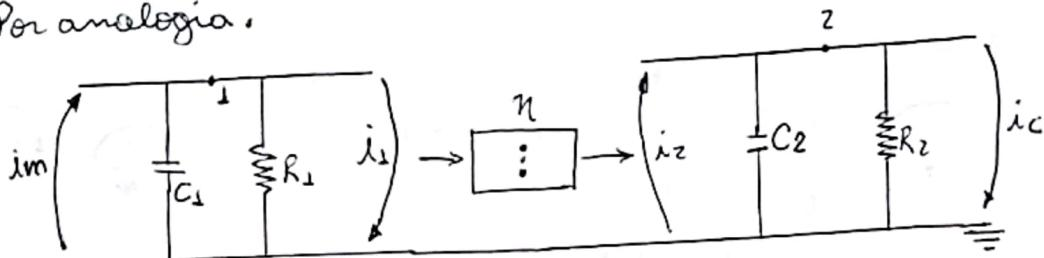
Nó 1:  $(C_1 D + \frac{1}{R_1}) V_1 = i_m \cdot i_1$ ; Nó 2:  $(C_2 D + \frac{1}{R_2}) V_2 = i_2 - i_c$
