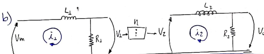
Malha 1:  $L_1 D i_1 + R_1 i_1 = V_m - V_1$
