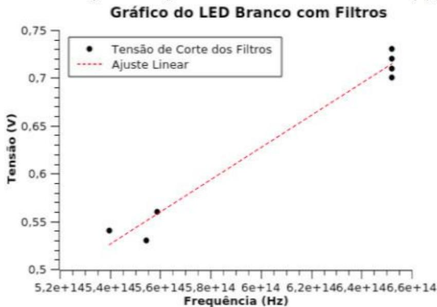
**Figura 5:** Gráfico das fontes de LED Branco com Filtros no qual através de suas tensões de corte e a frequência espectral foi possível ficar a equação (1).
