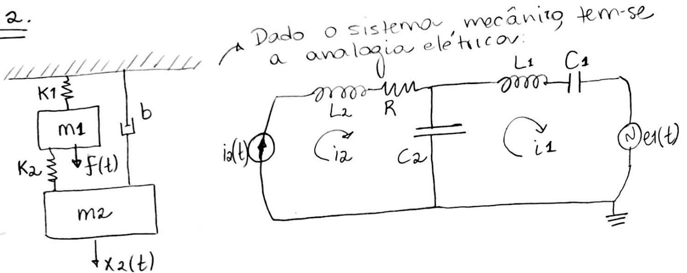
↗ Dado o sistema mecânico, tem-se a analogia elétrica:
