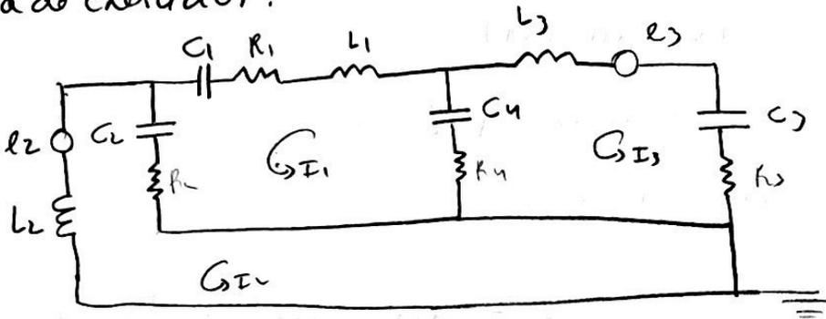
malha 1:  $(L_1 D + R_1 + \frac{1}{C_1 D}) i_1 + (i_1 - i_2) (R_2 + \frac{1}{C_2 D}) + (i_1 - i_3) (\frac{1}{C_4 D} + R_4) = 0$
