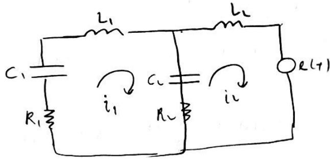
$$\text{malha 1: } L_1 D i_1 + \frac{1}{C_1 D} i_1 + R_1 i_1 + \frac{1}{C_2 D} (i_1 - i_2) + R_2 (i_1 - i_2) = 0$$
