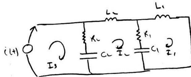
$$L_1 D i_1 + (i_1 - i_2) \left( R_1 + \frac{1}{C_1 D} \right) = 0$$
