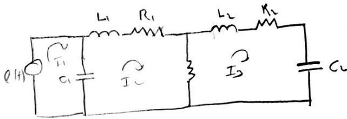
malha 1:  $\frac{1}{C_1 D} i_1 = T(t)$  ; malha 2:  $(L_1 D + R_1) i_2 + R_2 (i_2 - i_3) + \frac{1}{C_2 D} (i_2 - i_3) = 0$
