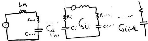
malha i:  $R_i (i_i - i_{i-1}) + \frac{1}{C_{i-1} D} (i_i - i_{i-1}) + \frac{1}{C_i D} (i_i - i_{i+1}) + R_{i+1} (i_i - i_{i+1}) + L_{i-1} D i_i = e_i(t)$
