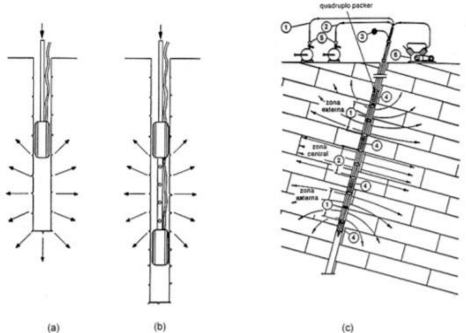
Ensaio Lugeon: a) - obturador simples; b) – obturador duplo, c) – obturador quádruplo.
