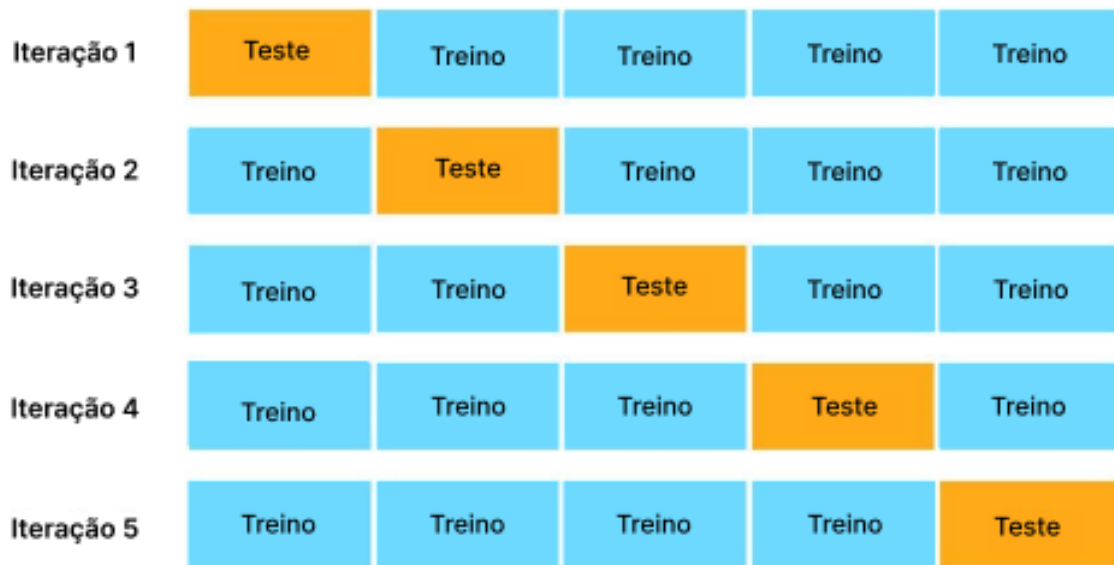
Figura 3. Ilustração de como o método K-fold separa a base em subconjuntos, nos quais em cada iteração um será utilizado como teste e os outros como treinamento. (adaptada de https://www.section.io/engineering-education/how-to-implement-k-fold-cross-validation/ )
